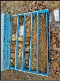
Fotografia 3. Detall dels materials del segon nivell tal i com es recuperen en el sondag a rotació realitzat.
